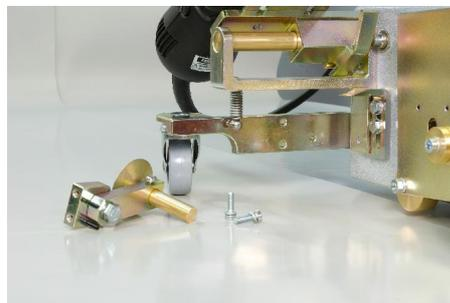
2.) Montieren Sie die Saumschiene am Automaten. Die Befestigung erfolgt am Lenkrollenhalter.
