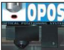
OPOS SE, das leistungsgesteigerte optische Positionierungssystem der SummaCut SE scannt die, auf Folie gedruckten Registriermarkierungen. Danach richtet die interne Programmierung des Schneideplotters, die Schneidedaten selbstständig neu aus, wobei Rotationen und Verformungen ausgerichtet werden. Das Ergebnis ist ein automatisches und präzises Konturschneiden von bedruckten Folien.
