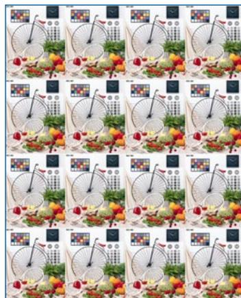
**Das von BLI verwendete, aus 4 x 4 in Fliesenform angeordneten Rechtecken des Testmusters JIS SCID No.5 bestehende Testbild**
