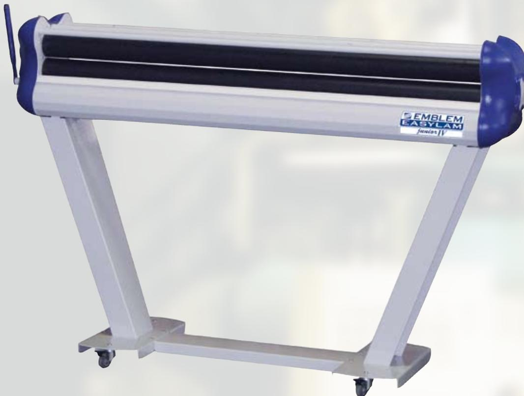
Der **EMBLEM EASYLAM junior IV** ist ein groß-formatiger Kaltlaminator, der ein Laminieren bzw. Kaschieren beliebigen Materials bis zu einer Maximalbreite von 1400 mm ermöglicht. Die Gummiandruckwalzen mit einem Durchmesser von 80mm können bis zu 30mm geöffnet werden, was eine Vielzahl zu laminierender bzw. kaschierender Materialien zulässt.
