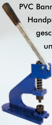
Durch Wechsel des Werkzeugs besteht die Möglichkeit auch EMBLEM Metallösen von 6,35 mm - 11 mm zu verarbeiten.
