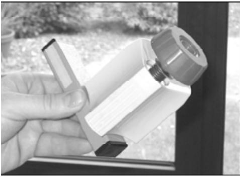
Wir heben das Trägerpapier an und bekleben das Laminat mit einem 10 cm langen „Parkstreifen“ auf der gesamten Breite des Laminats. Das Trägerpapier darf hierfür nicht abgeschnitten werden und muss so lang bleiben wie das Laminat ! Das Trägerpapier wird wieder zurückgeklappt.
