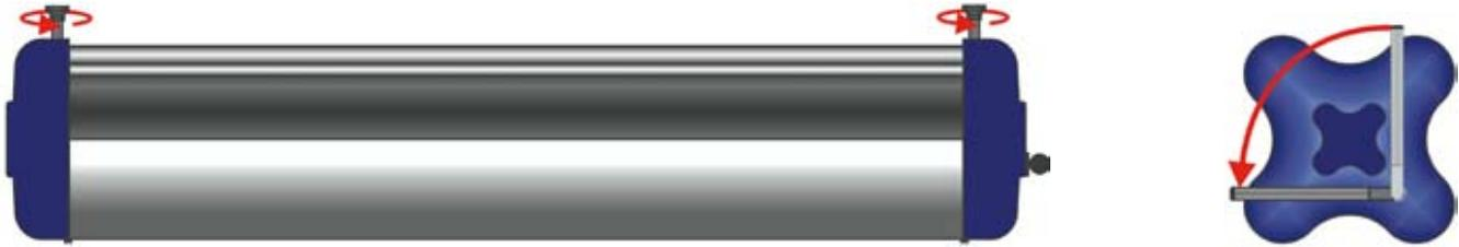
Beide Stellschrauben des Laminators bis zum oberen Anschlag ( Lage 0 ) herausdrehen ( im Gegenuhrzeigersinn ).
