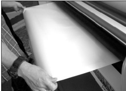
Trägerpapier an den „Eselsohren“ fassen und ca. 20 cm abziehen, danach das Papier mittels der Klemmen von unten an Aufwickelachse befestigen.
