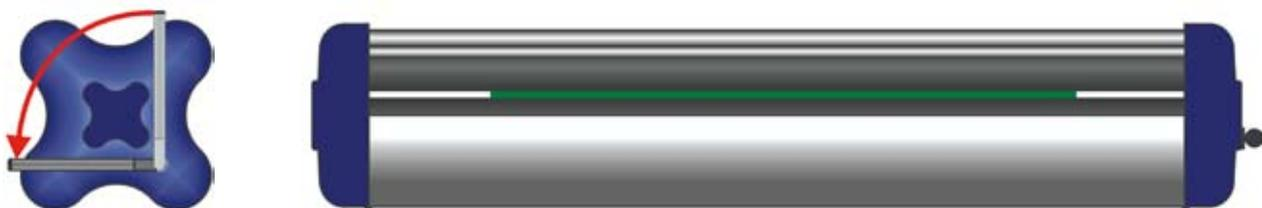
7. Den Andruckhebel herunter klappen. Dadurch wird der für die richtige Funktion des Laminators mit dieser Plattenstärke benötigte Andruck erreicht.
