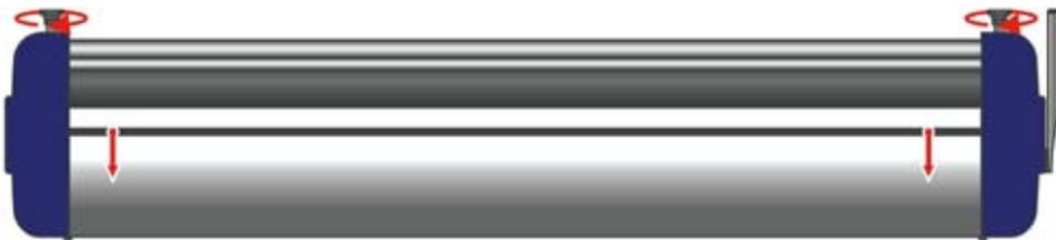
2. Beide Stellschrauben des Laminators herunterschrauben ( im Uhrzeigersinn ). Zwischen den Walzen muss eine Lücke sein, die 5 – 10mm größer ist, als die Stärke des Materials ( Platte ).
