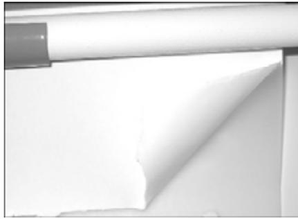
Andruckwalzen mittels Hebel lösen Laminat durch Andruckwalzen ziehen (s.u.) und Andruckwalzen wieder festsetzen.
